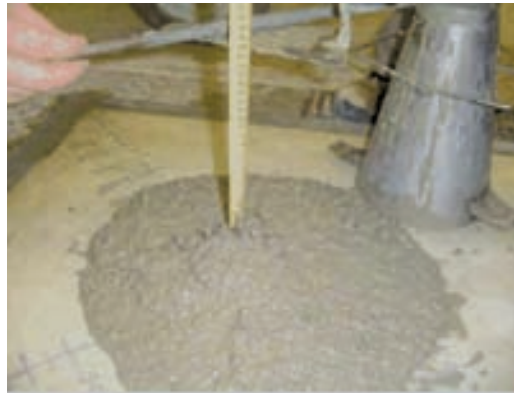
Figura 3: Misura della lavorabilità dell'impasto
