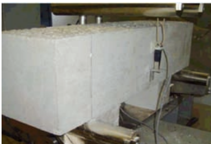
Figura 5: Set-up della prova di flessione
